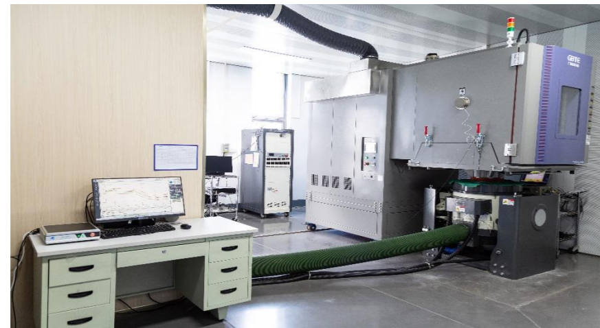
온도, 습도 및 진동 테스트 장비
